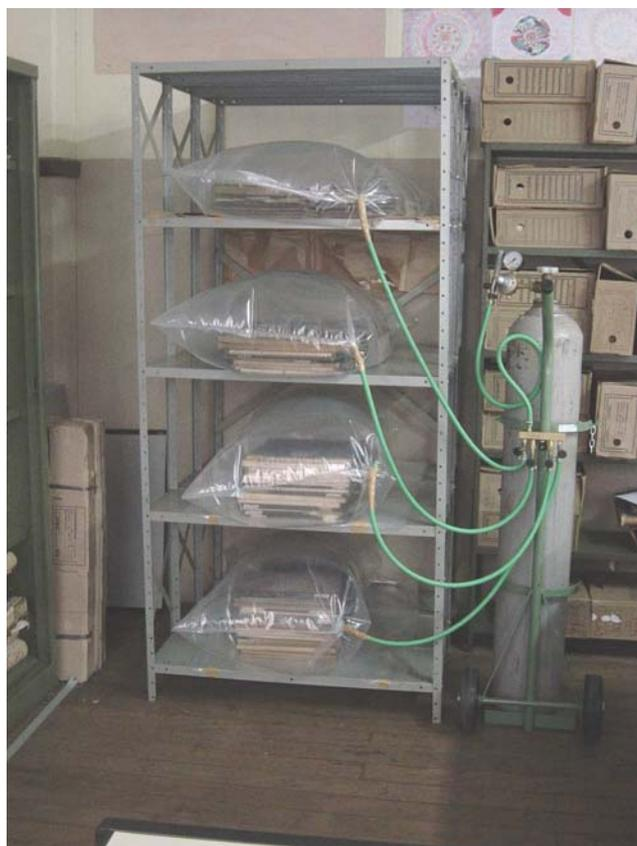
Figura 5 – Kit de desinfestação, composto por tubo de nitrogênio que, acionado por uma válvula, transporta o nitrogênio para os sacos plásticos, pelas mangueiras que os ligam
